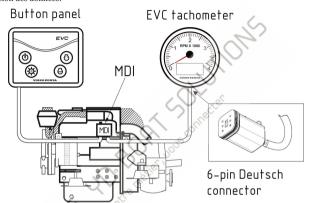
Figure 2. Moteur Volvo Penta avec tachymètre MDI et EVC
