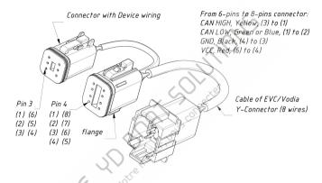
Figure 1. Adaptateur pour connecteur EVC / Vodia à 8 broches
