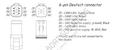
Figure 2. Connecteurs du moteur, DT04-6P (mâle, gauche) et è DT06-6S (femelle, droite)
